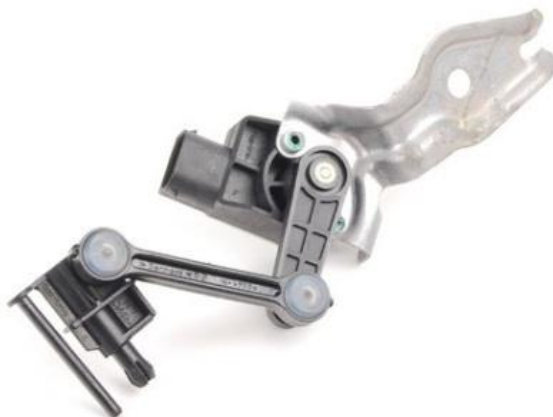
Рис. 12.3. Общий вид датчика положения кузова
