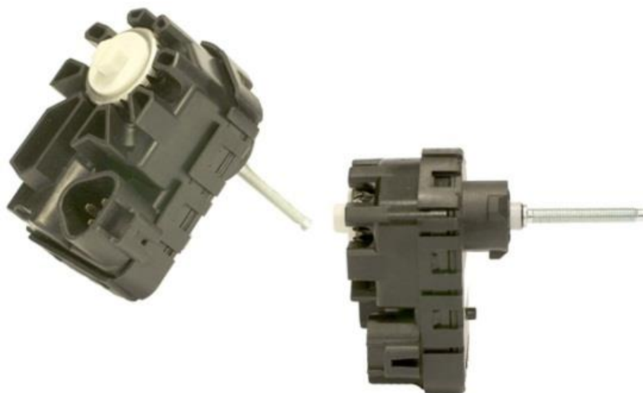
Рис.12. 4. Общий вид привода автоматического корректора фары
